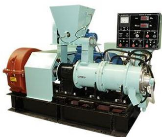
Самый рациональный и простой процесс переработки резины и пластмассовых изделий на сегодняшний день основывается на методе высокотемпературного сдвигового и упруго-деформационного измельчения ее в крошку. Он позволяет максимально сохранить химические и физико-механические свойства.
