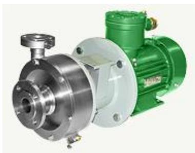
Производимые взрывозащищенные химические насосы являются центробежными, герметичными. По своей конструкции — горизонтальные, моноблочные. Имеют магнитную муфту. Проточная часть электрических насосов изготовлена из нержавеющей стали **12Х18Н10Т**. Производство герметичных химических насосов осуществляется в двух исполнениях: обычном (ХЦМ Q/H-K) с общепромышленным двигателем и взрывозащищенном (ХЦМ Q/H В-К) с электродвигателем во взрывобезопасном исполнении.
