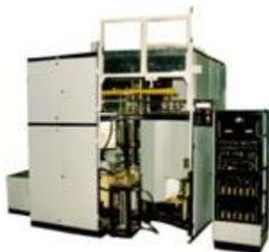
**Назначение:** Установка карусельного типа предназначена для очистки подшипников от отработанной смазки ЛЗ-ЦНИИ. Обработка одновременно двух подшипников.
