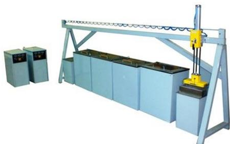
Транспортер полуавтоматический предназначен для обеспечения возможности перемещения по позициям обработки очищаемых изделий в технологической таре (корзинах) или непосредственно при использовании комплекса ультразвуковой очистки "Кристалл-50К".
